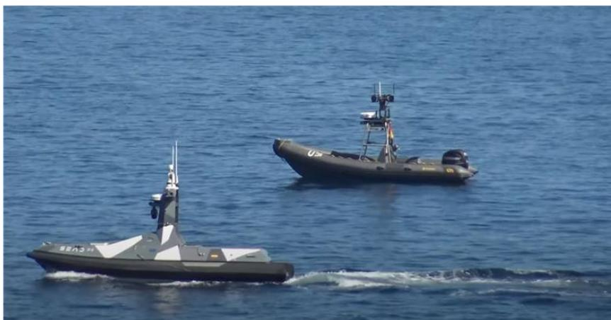
Figura 3. Vehículo no tripulado de superficie (USV) Sead 23, de SEADRONE. Integración completa del sistema para llevar el control y carga de pago por 5G.
