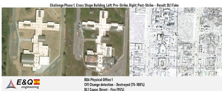
Figura 4. Resultados de la aplicación de los algoritmos de análisis de daño por imagen mediante el sistema CADET durante el Hackathon de ACT 2021. Fuente: E&Q Engineering.
