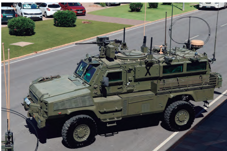
El vehículo pesado RG-31 Nyala es un transporte blindado de personal, resistente a las minas y a los IED, que acompaña a los equipos de control aerotáctico (TACP).
