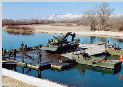
De Tablero Flotante (PTF) MAN. 1972/en servicio.
