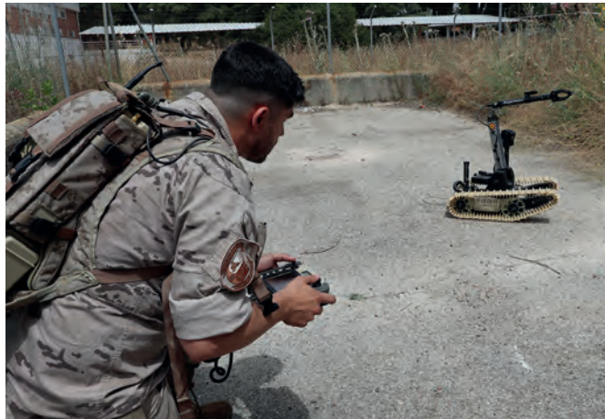
Un miembro del equipo EOD maneja el robot Dragon Runner , dotado con cañón disruptor para desbaratar objetos sospechosos.
