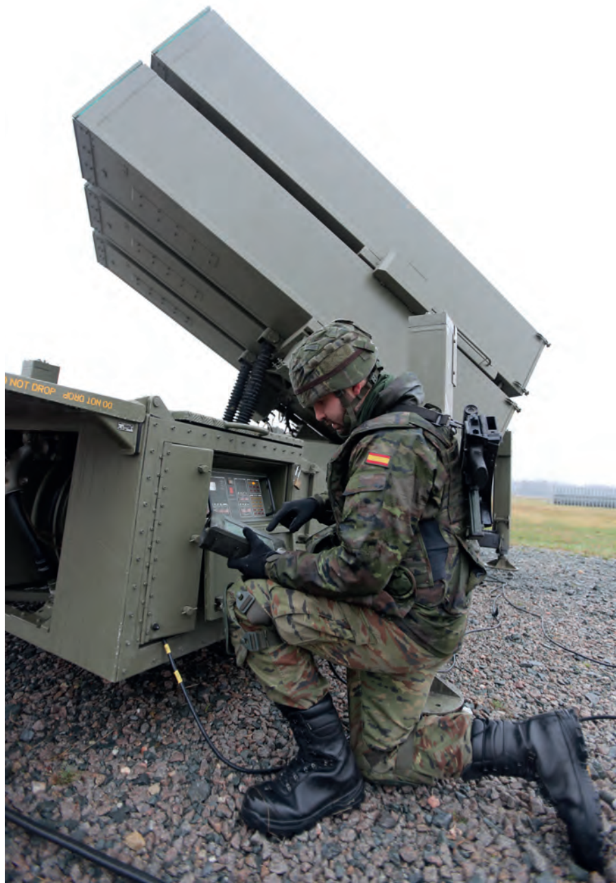
Arriba, el jefe de uno de los dos lanzadores de la batería NASAMS introduce los datos de lanzamiento del misil en la plataforma. Debajo, interior del puesto de mando del sistema HALO.
