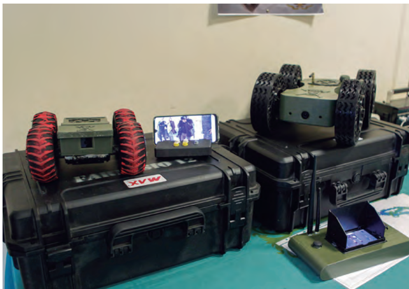
Los UGV de exploración se fabrican íntegramente en el Regimiento con impresoras 3D.
