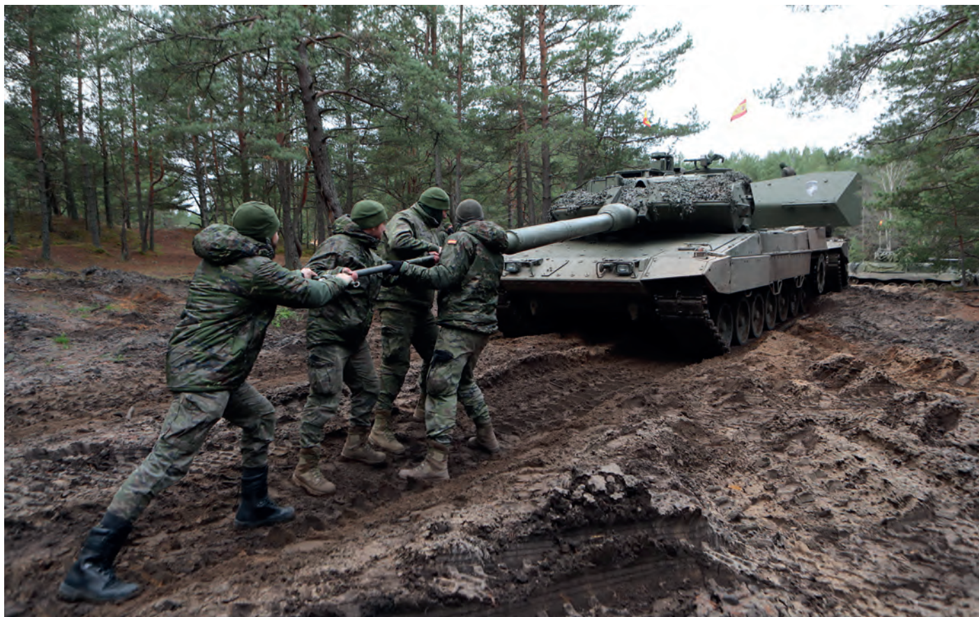
Los cuatro miembros de la dotación de un carro de combate Leopard 2E limpian el cañón de 120 mm sobre el terreno momentos antes de entrar en acción.
