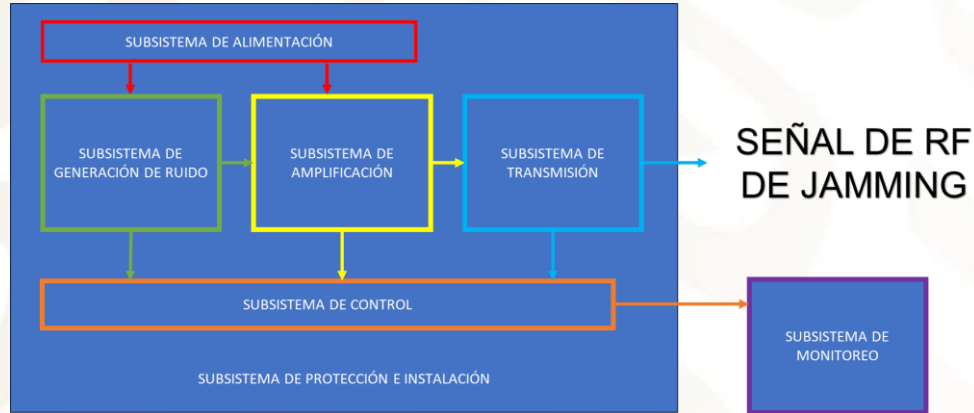
Diagrama a Bloques Sistemas JAMMING contra Drones
